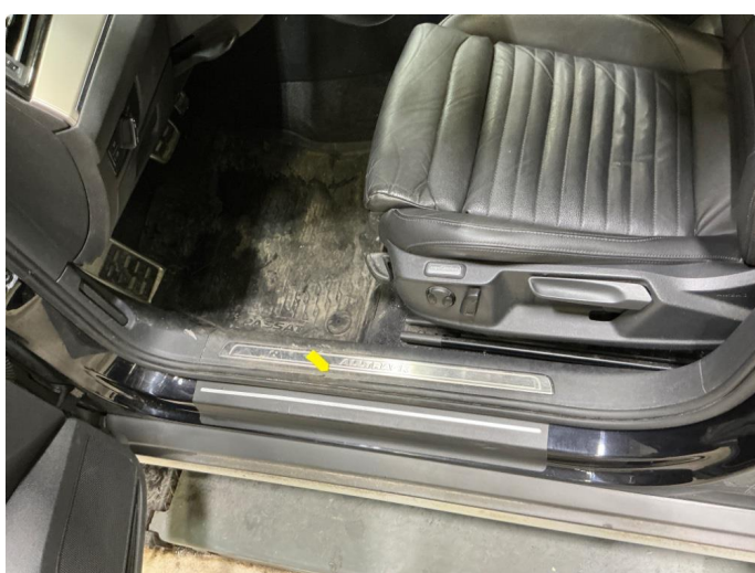
1.4 Indre tetteliste førerdør er skadet.
