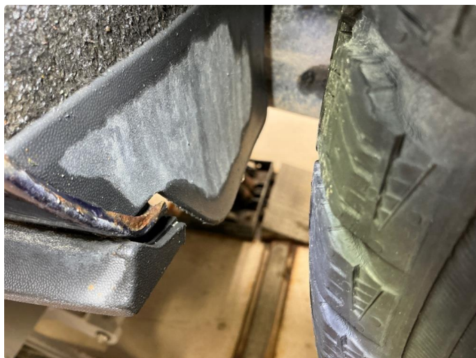
1.4 Baksjerner begge sider - rust hjulbue foran hjul + bakhjul høyre side
