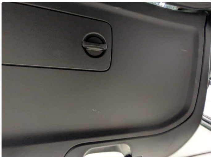
2.1 Lite hakk i dørtrekk, underkant.
