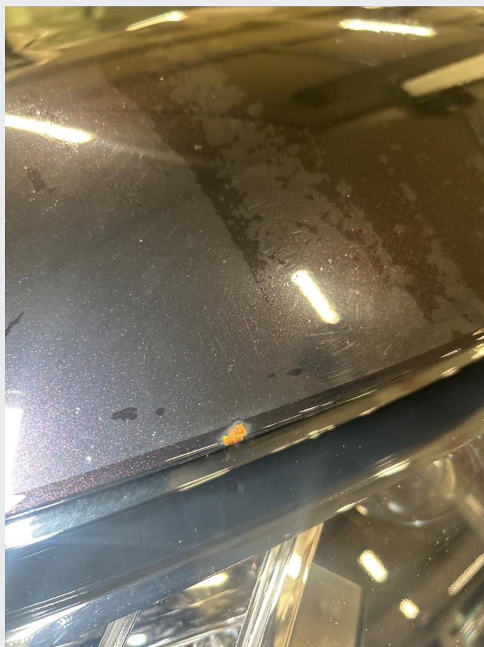
2.3 Riper, steinsprut og rustfleck på panser
