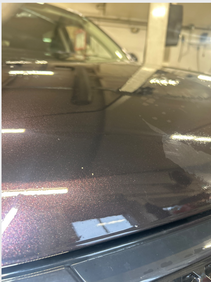
2.3 Riper, steinsprut og rustfleck på panser
