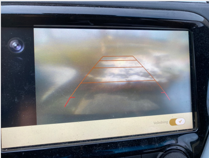
4.2 Uklart ryggekamera, slitt linse
