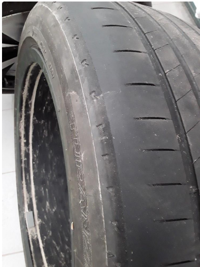
1.3 2 av sommerhjulene er nedslitt. 2 stk nye bestilt og monteres før levering.
