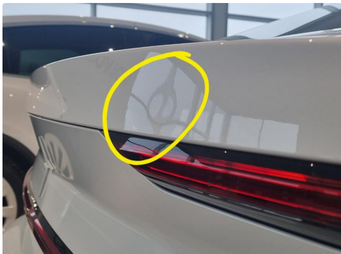
1.1 Liten bulk uten lakkskade på bakluke, rett over høyre baklykt
