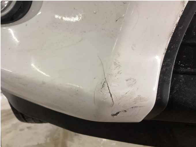
1.1 Liten sprekk nederst på støtfanger
