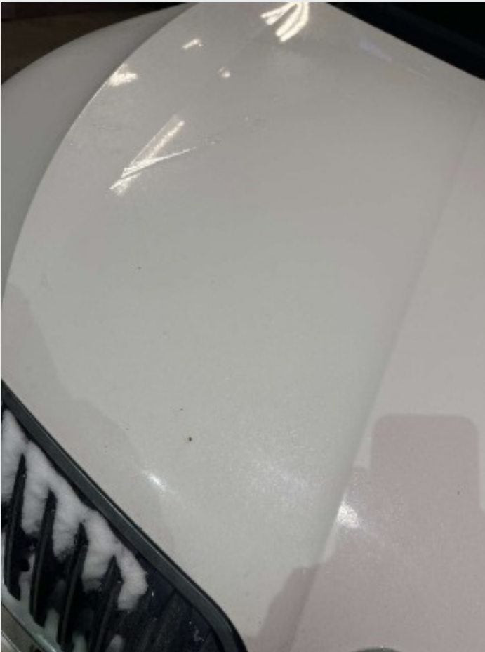
2.3 steinsprut på panser(vedlegg).
