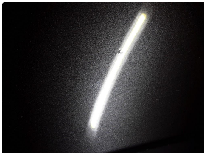
1.1 Steinsprut med korrosjon.
