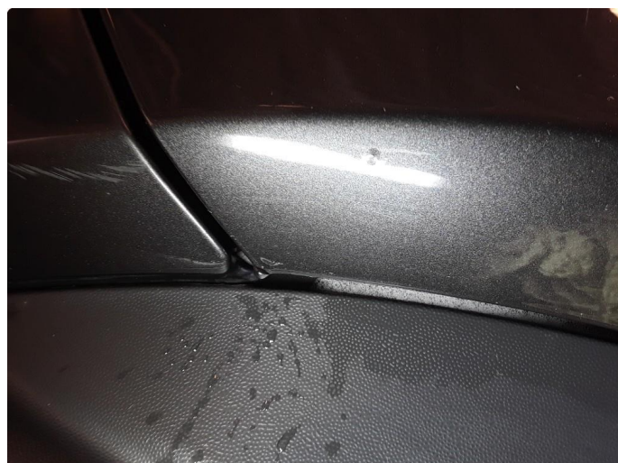
1.2 Steinsprut med korrosjon.
