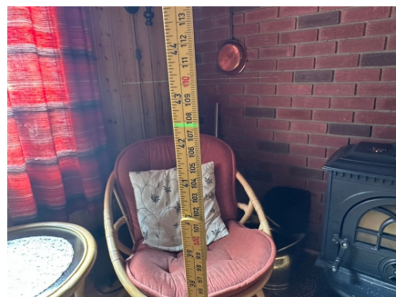
Stue vest 107,9cm, avvik på 14mm målt i en diameter på 2m.
