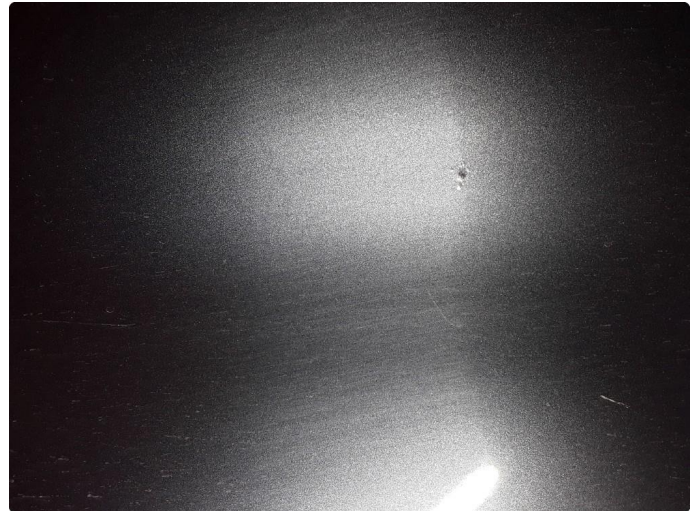
1.2 Liten steinsprut med korrosjon.
