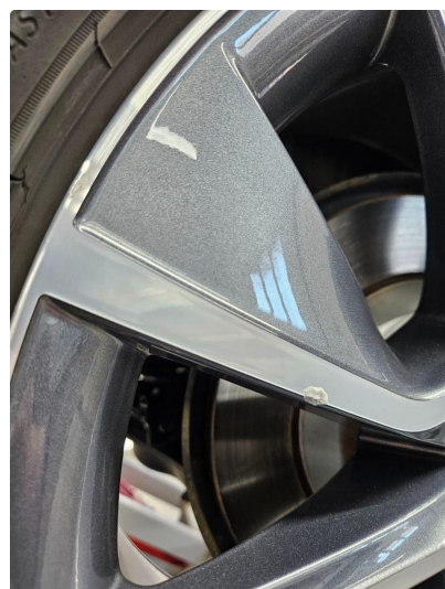
1.2 Noe skrubbermerker på alu.felger, anmerket
