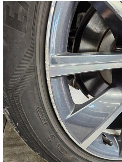
1.2 Noe skrubbermerker på alu.felger, anmerket
