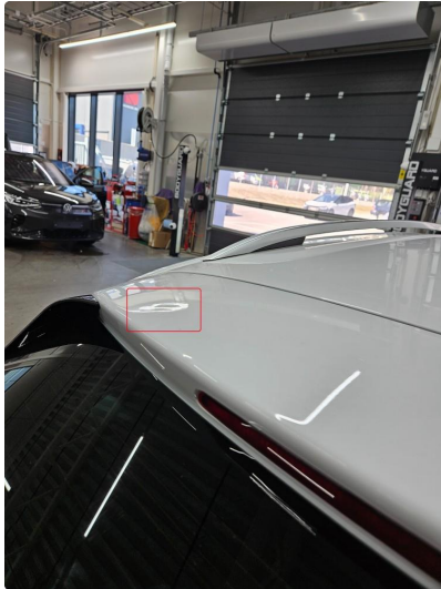
1.1 Liten bulk (uten lakkskade) på topp av bakluke, v.side, anmerket
