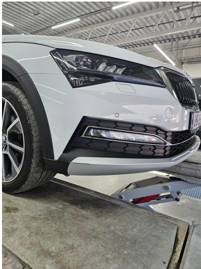
1.4 Noen riper på plast-fanger, h.side foran, blitt penslet m/lakk
