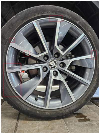
1.2 Noe skrubbermerker på alu.felger, anmerket
