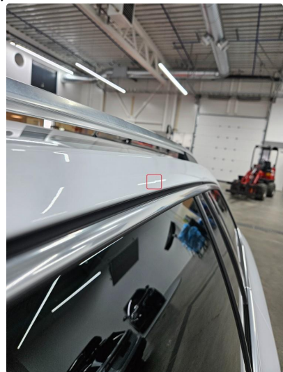
1.5 Liten bulk (uten lakkskade) på takvange v.side, anmerket
