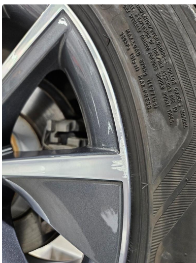
1.2 Noe skrubbermerker på alu.felger, anmerket
