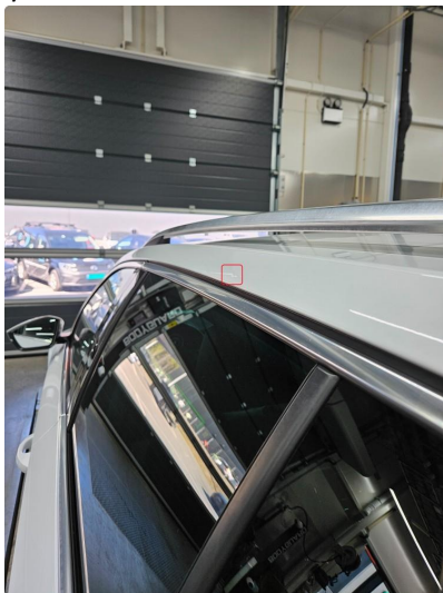
1.5 Liten bulk (uten lakkskade) på takvange v.side, anmerket
