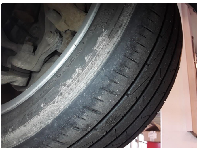
1.3 Skjev slitasje på sommerdekk
