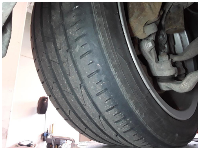
1.3 Skjev slitasje på sommerdekk
