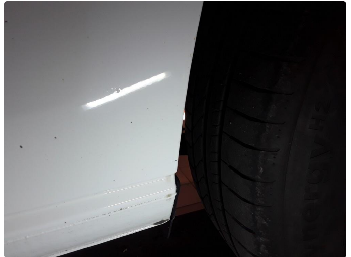
1.3 Liten steinsprut med korrosjon.
