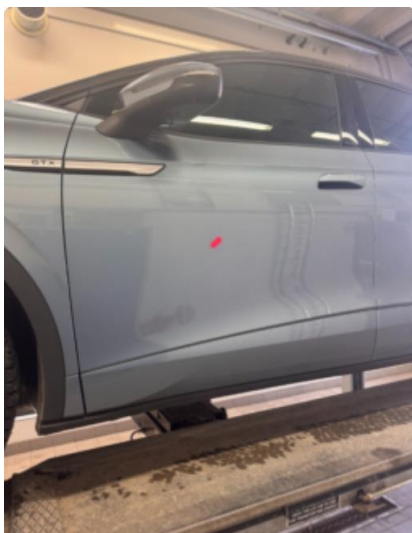
1.2 Liten steinsprut med korrosjon venstre fordør.
