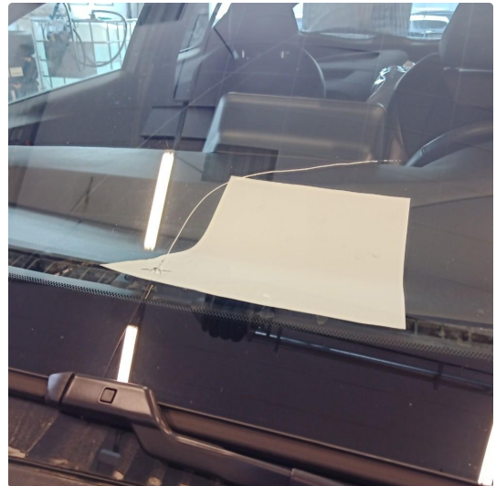
1.6 Steinsprut med sprekk utenfor synsfelt. FRONTRUTE BYTTES.
