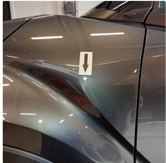
1.2 Bulk med lakkskade
