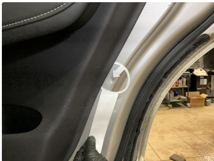
1.6 Liten bulk på innside av høyre bakdør.
