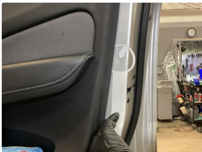
1.7 Flere små ubetydelige bulker på innside av høyre framdør.
