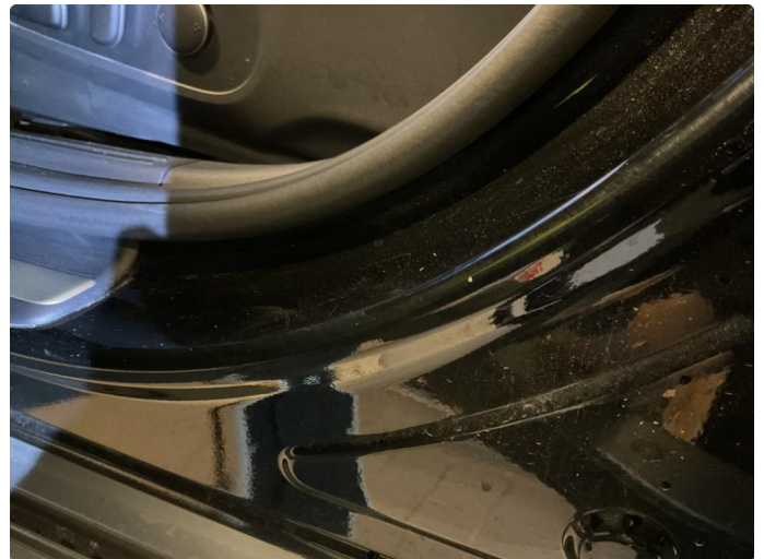
1.2 Noe bruksmerker innsteg begge dører foran
