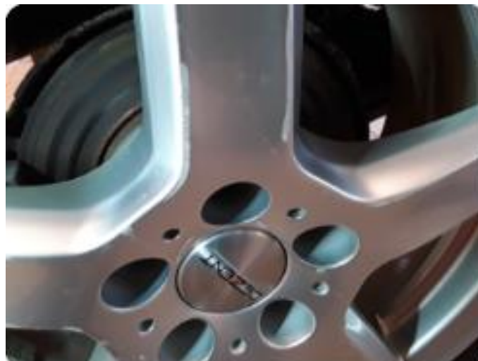
1.3 2 noe kantkjørte vinterfelger.
