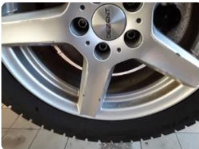
1.3 2 noe kantkjørte vinterfelger.
