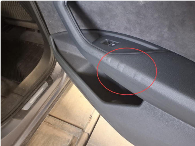
2.1 Skadet/merker etter utstyr
