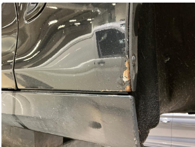
1.3 Høyre skjerm foran - rust
