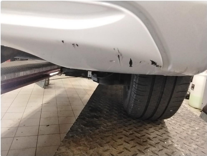
1.1 Ripe(r) ned til grunning
