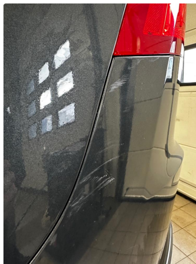
1.5 Ripe(r) ned til grunning
