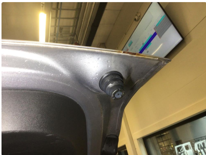
1.3 Noe korrosjon i fals på bakluke
