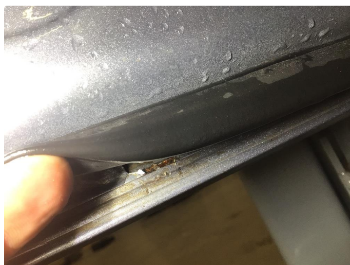
1.2 Noe korrosjon i fals på alle dører
