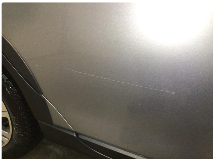
1.1 Ripe på høyre bakdør blir utbedret med smart repair
