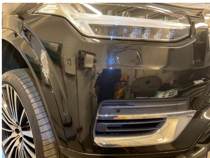
1.5 Noe små steinsprut frontfanger foran.
