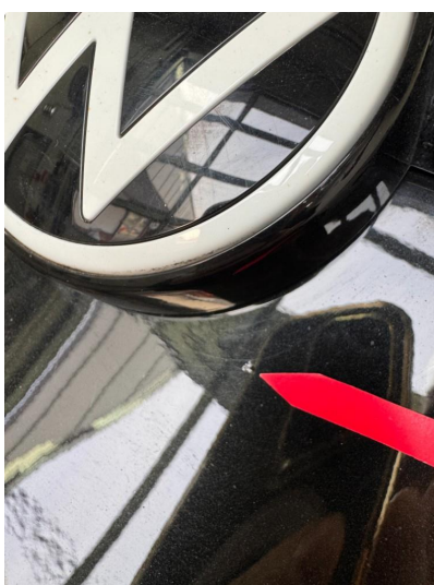
1.3 Liten steinsprut med korrosjon.
