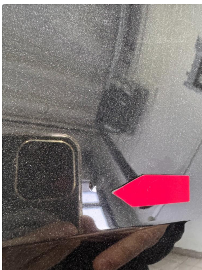
1.3 Liten steinsprut med korrosjon.
