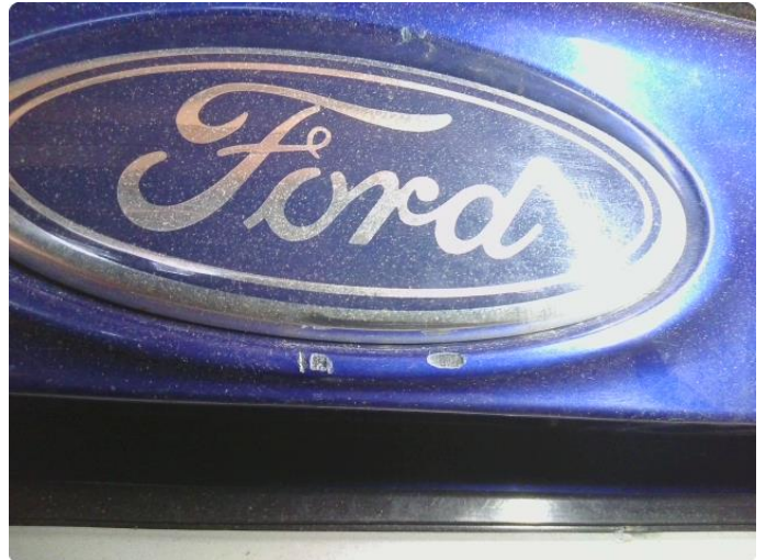
2.3 Lakkskade noen steder på bakluken
