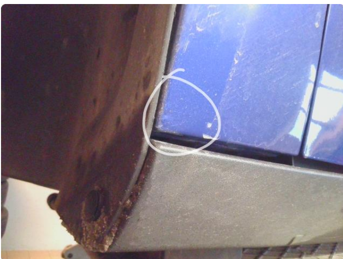
2.4 Steinsprut med lakkskade. Missfarget.
