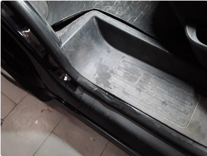
1.2 Noe slitasje på dørpakning i førerdør. Normal bruksslitasje
