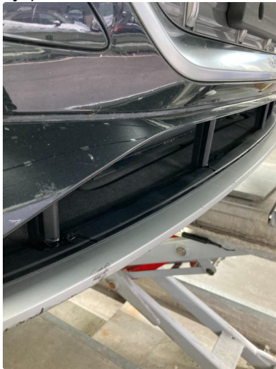
1.2 Spiler i nedre grill har blitt limt.
