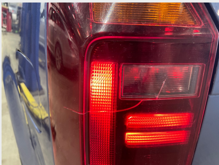
3.2 Sprekk på baklykt glasset
