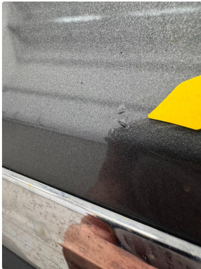
1.2 Liten steinsprut med korrosjon.
