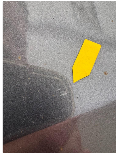
1.2 Liten steinsprut med korrosjon.
