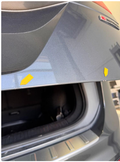
1.4 Noe sår med korrosjon.
