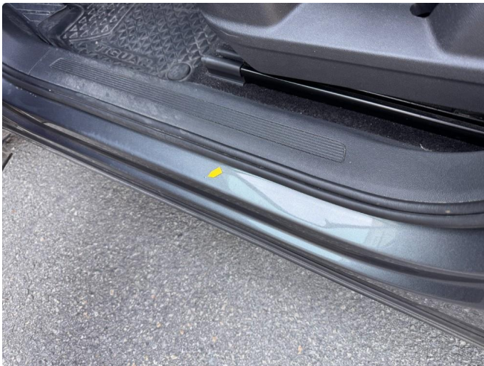
1.6 Lite sår med korrosjon venstre foran.
