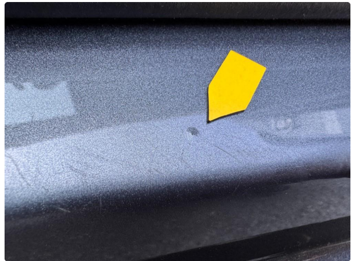
1.6 Lite sår med korrosjon venstre foran.
