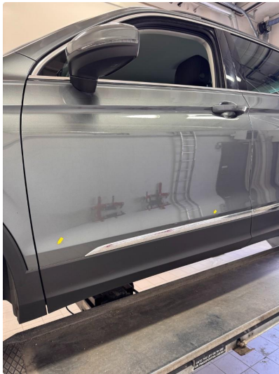
1.2 Liten steinsprut med korrosjon.
