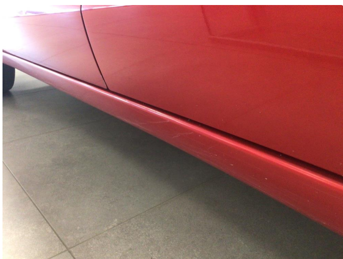
1.2 Noe riper og små bulker rundt på bil, det anses som normal bruksslitasje
