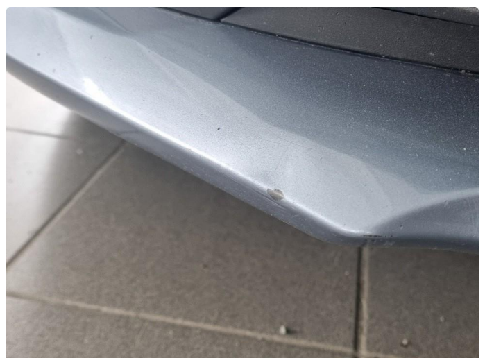
1.2 Liten bulk med lakkskade nederst på frontfangeren
