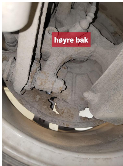
4.1 Bremseskjold, venstre foran; mangler Bremseskjold begge sider bak er betraktelig korrodert med hull
