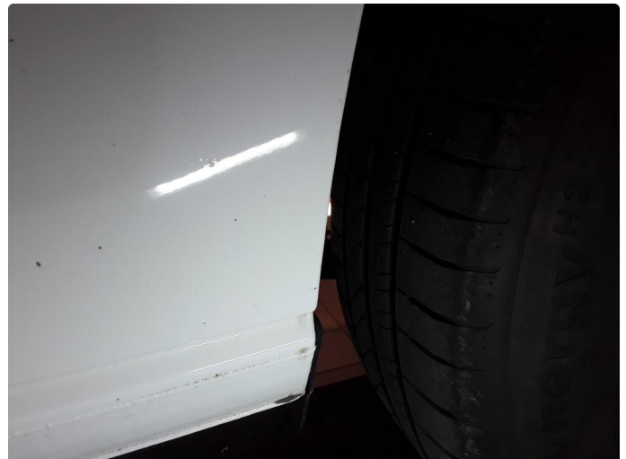
1.3 Liten steinsprut med korrosjon.
