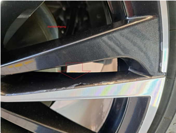
1.1 Små kantsår venstre foran , noe lakkavflissing begge bak
