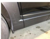
1.1 Noe riper på skjermutbygger høyre side bak, dette anses som normal bruksslitasje
