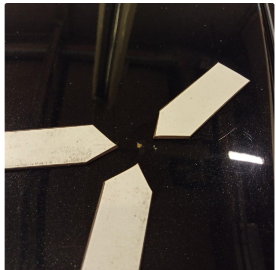
1.6 Steinsprut med litt rust 10 000kr
