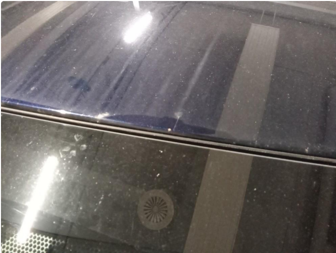
1.1 Steinsprut med rust
