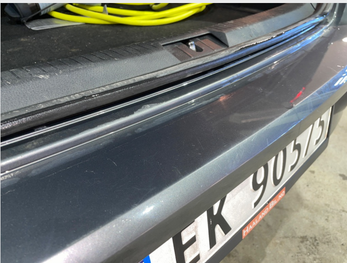
2.8 små riper på støtfanger bak under bakluke
