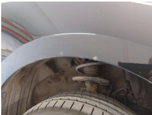
2.9 Steinsprut med rust
