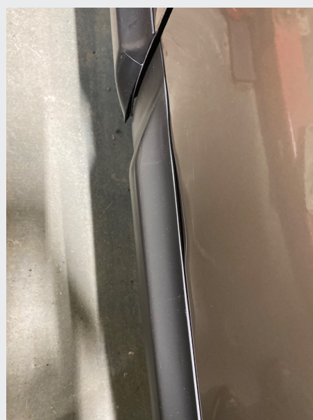
2.8 Bakfanger, en del slitasje innsteg til bagasjerom
