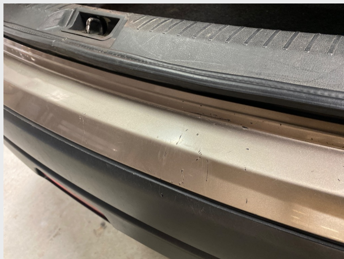
2.8 Bakfanger, en del slitasje innsteg til bagasjerom
