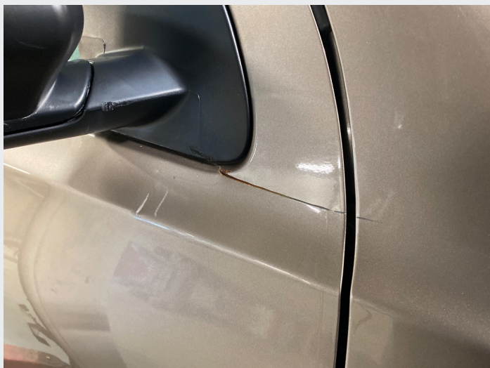
2.5 Skade høyre fordør
