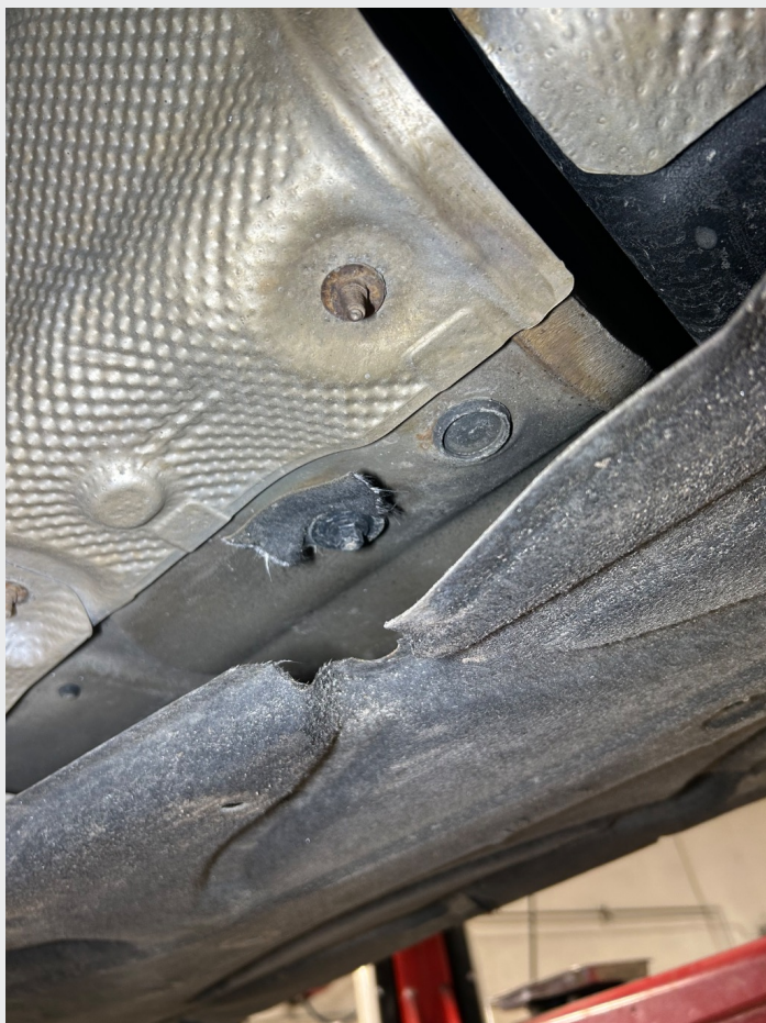
2.2 Plate langs høyre side under bil ødelagt + sprekk i plater under motor
