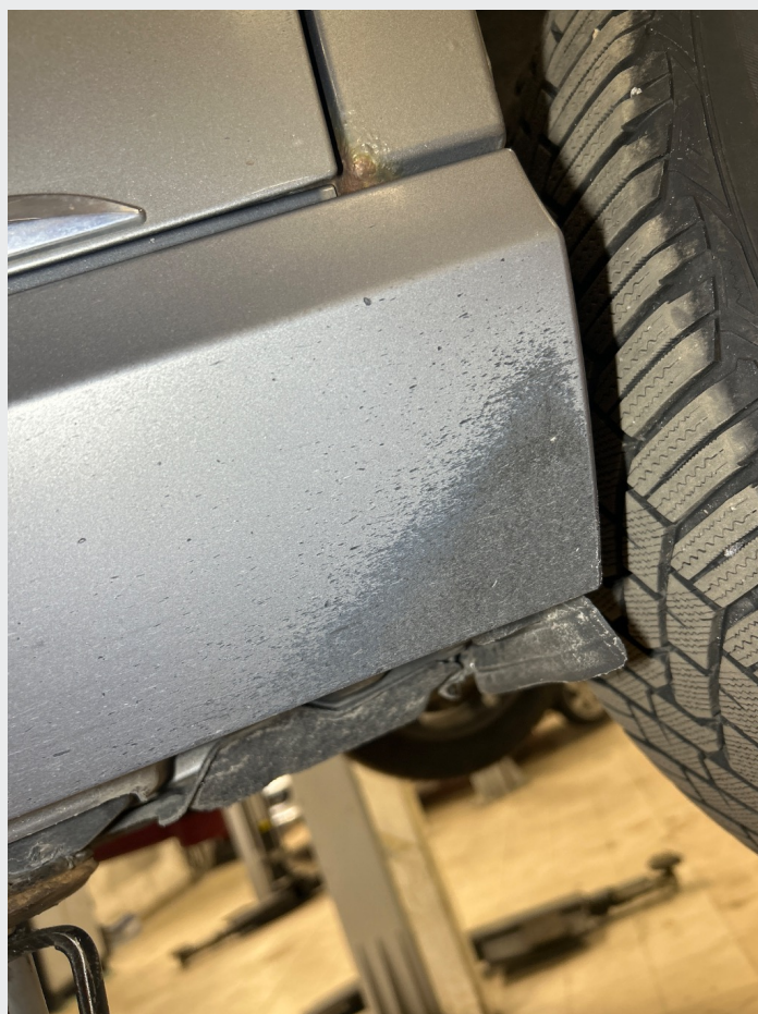
2.4 Skader i lakk på kanaldeksel v.s.
