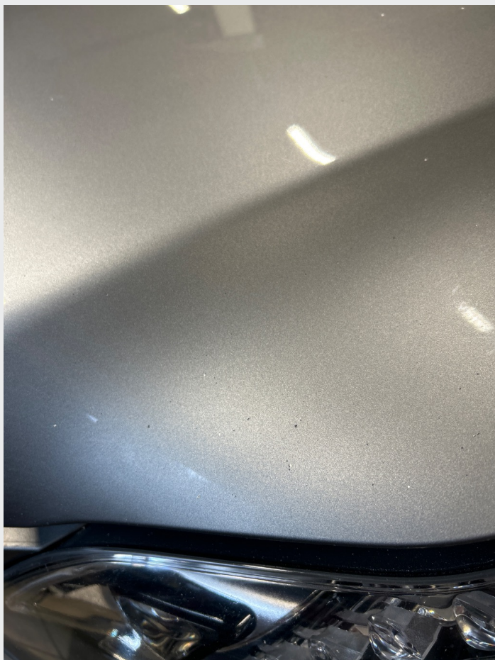
2.3 En del steinsprut på panser
