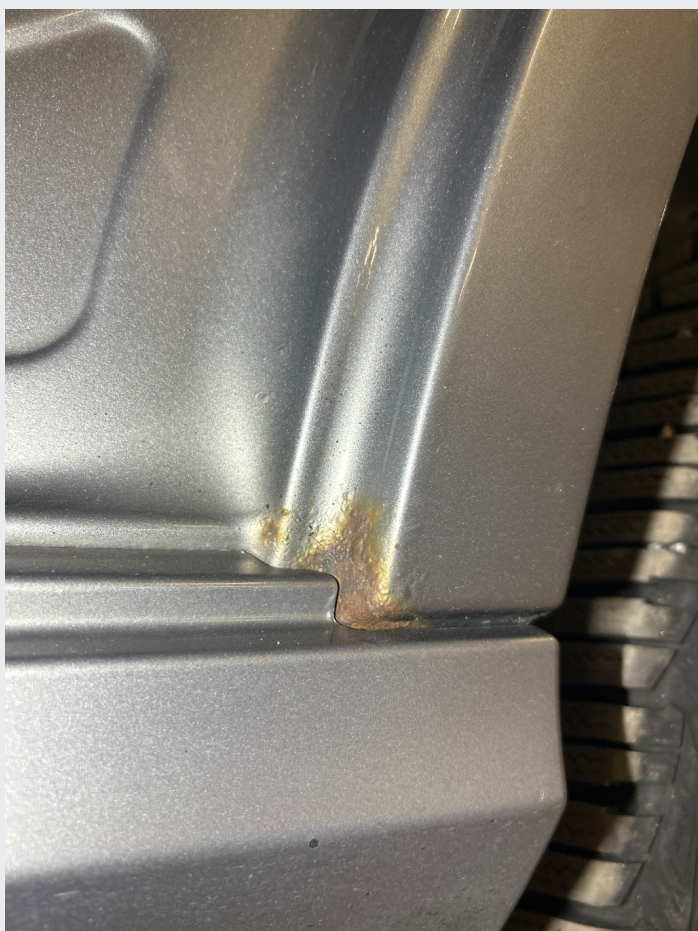
2.7 Rust på venstre bakskjerm, inn mot dør
