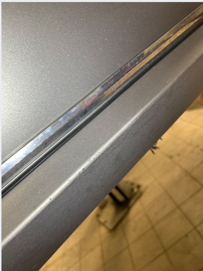
2.4 Skader i lakk på kanaldeksen h.s.
