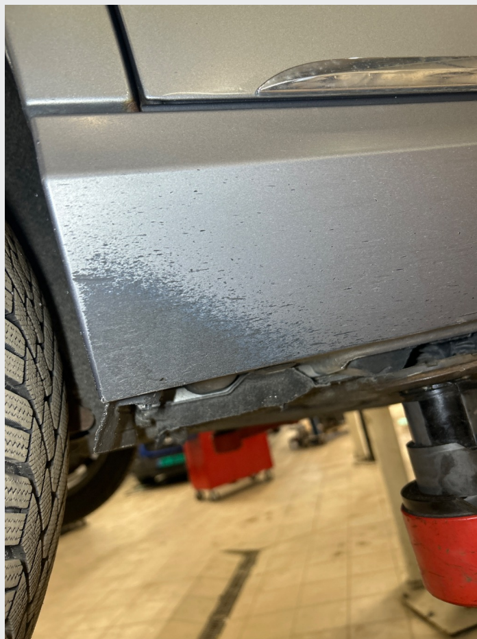
2.4 Skader i lakk på kanaldeksen h.s.
