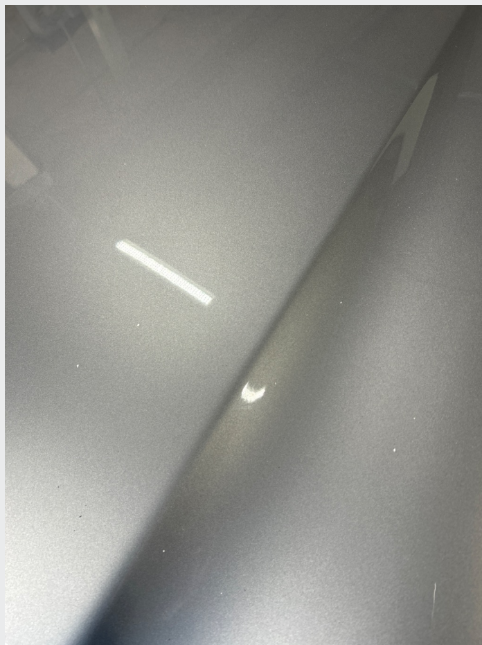
2.3 En del steinsprut på panser
