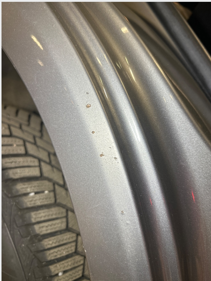
2.7 Steinsprut på høyre bakskjerm mot dør, begynt å ruste
