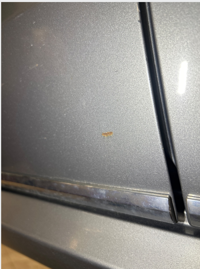
2.5 Skade i lakk på førerdør, begynt å ruste og liten bulk førerdør
