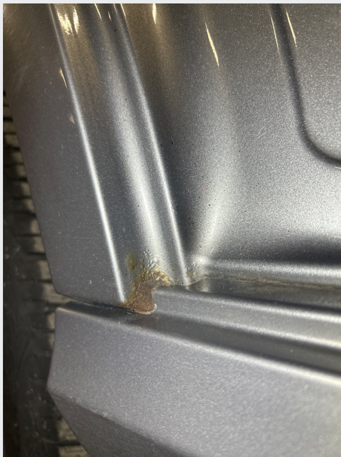
2.7 Rust på høyre bakskjerm, inn mot dør
