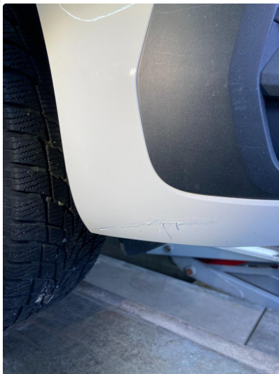
1.2 Ripe på høyre støtfangerhjørne foran. Har blitt penslet med lakk.
