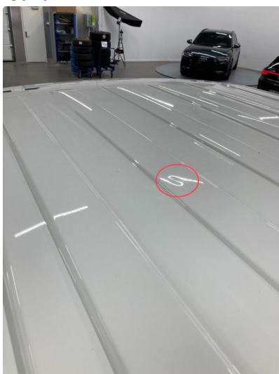
1.3 Noen småbulker på tak.
