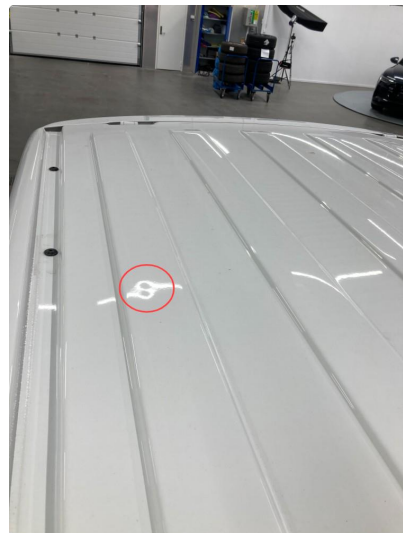
1.3 Noen småbulker på tak.
