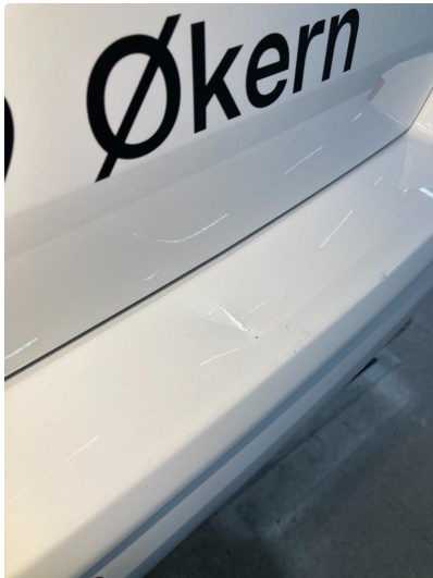
1.1 Liten sprekk og noen merker i støtfanger bak. Har blitt penslet med lakk.
