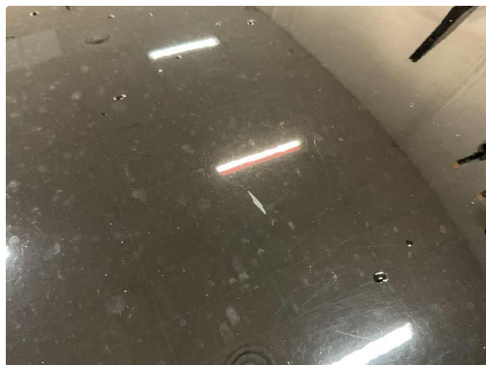
1.1 Noen steinsprang på panser
