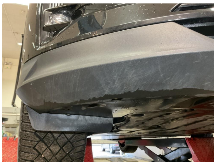
1.5 Noe skrubbeskader under støtfanger foran, høyre side.
