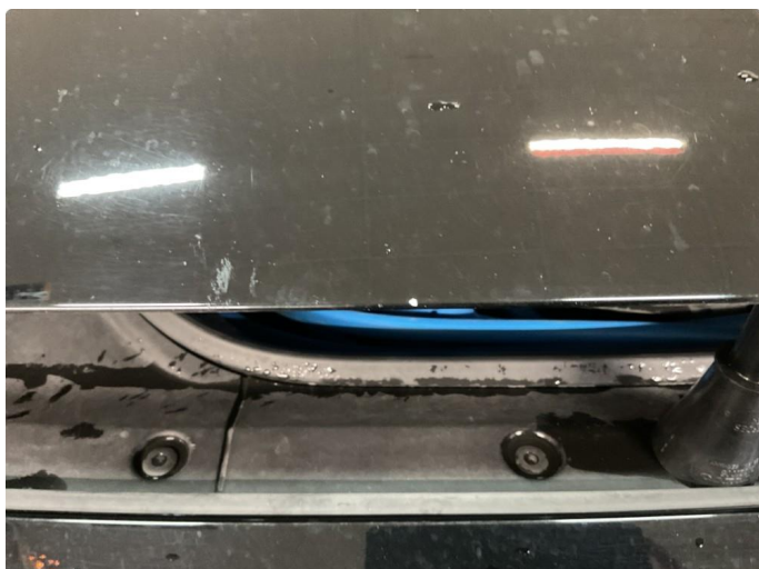
1.1 Noen steinsprang på panser
