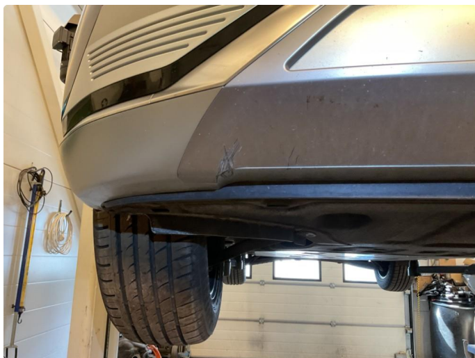
1.3 Noe skrubbskade underkant foran.
