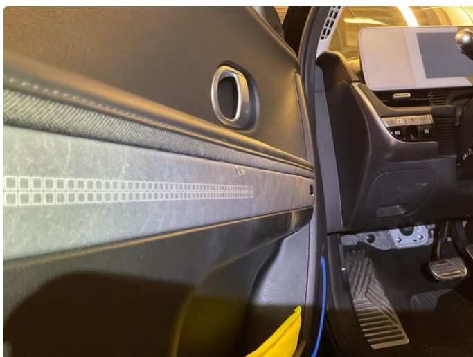
2.1 Noe merker på innvendig dørtrekk venstre foran.
