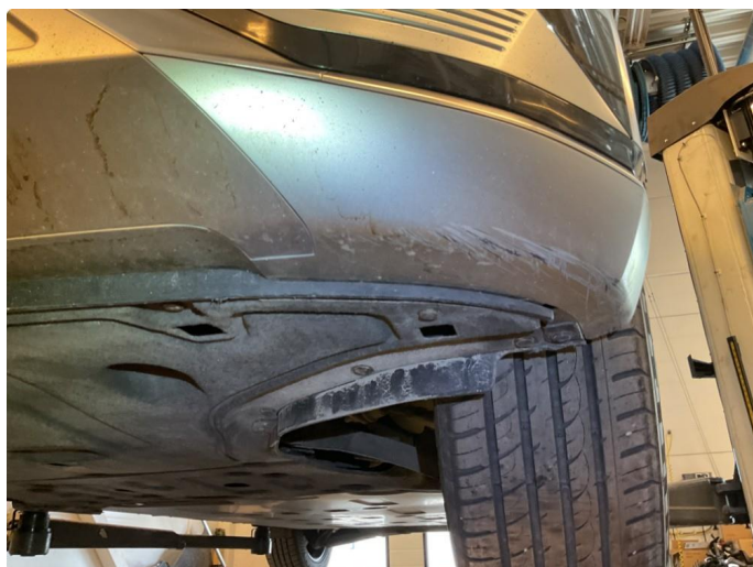
1.3 Noe skrubbskade underkant foran.
