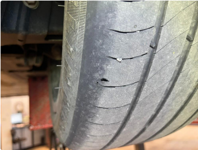
1.2 Skjev slitasje på sommerdekk/ nye sommerdekk
