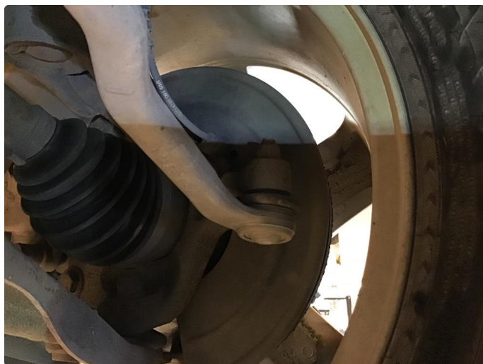
2.1 Skade/slitasje på ledd
