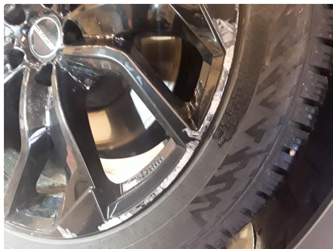
1.2 2 noe kantkjørte vinterfelger.
