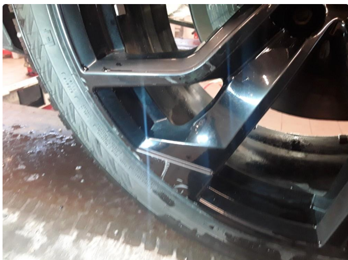
1.2 2 noe kantkjørte vinterfelger.
